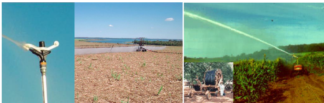
Figura A6 – Sistemas de Irrigação por Aspersão: Aspersor Convencional, Autopropelido de Barra, Canhão Autopropelido
